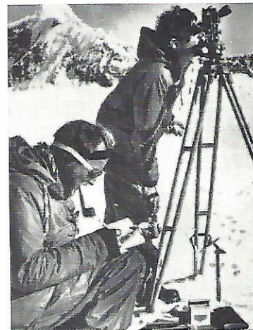
Leden van de karteringsgroep doen waarnemingen met een theodoliet op het Kohl-Larsenplateau.
